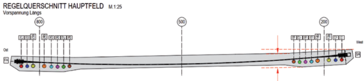
Bild 9 Querschnitt Hauptfeld mit Querspannliedverlauf und seitlich angeordneten Randbalken © schlaich bergemann partner
