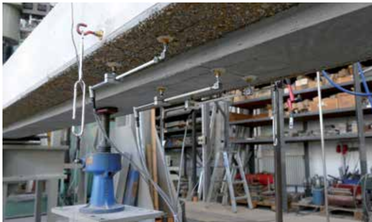
Bild 8 Prüfung der Großbauteile mit sechs Lagen Carbongelege Foto: Alexander Schumann, © CARBOCON
