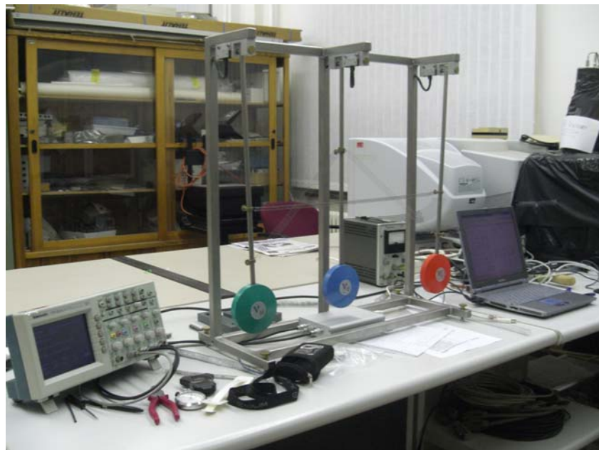
Abbildung 8: Die Messapparatur im Institut für Kern- und Teilchenphysik der TU Dresden bestand aus Oszilloskop, Pendel und Laptop (von links nach rechts).
