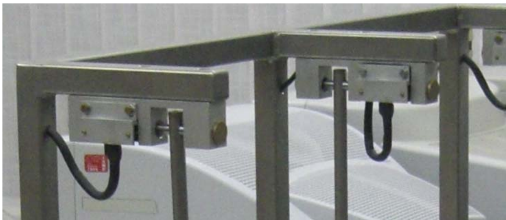
Abbildung 11: Elektronische Einrichtung am oberen Ende jedes Pendels zur Erfassung der Pendelschwingungen.
