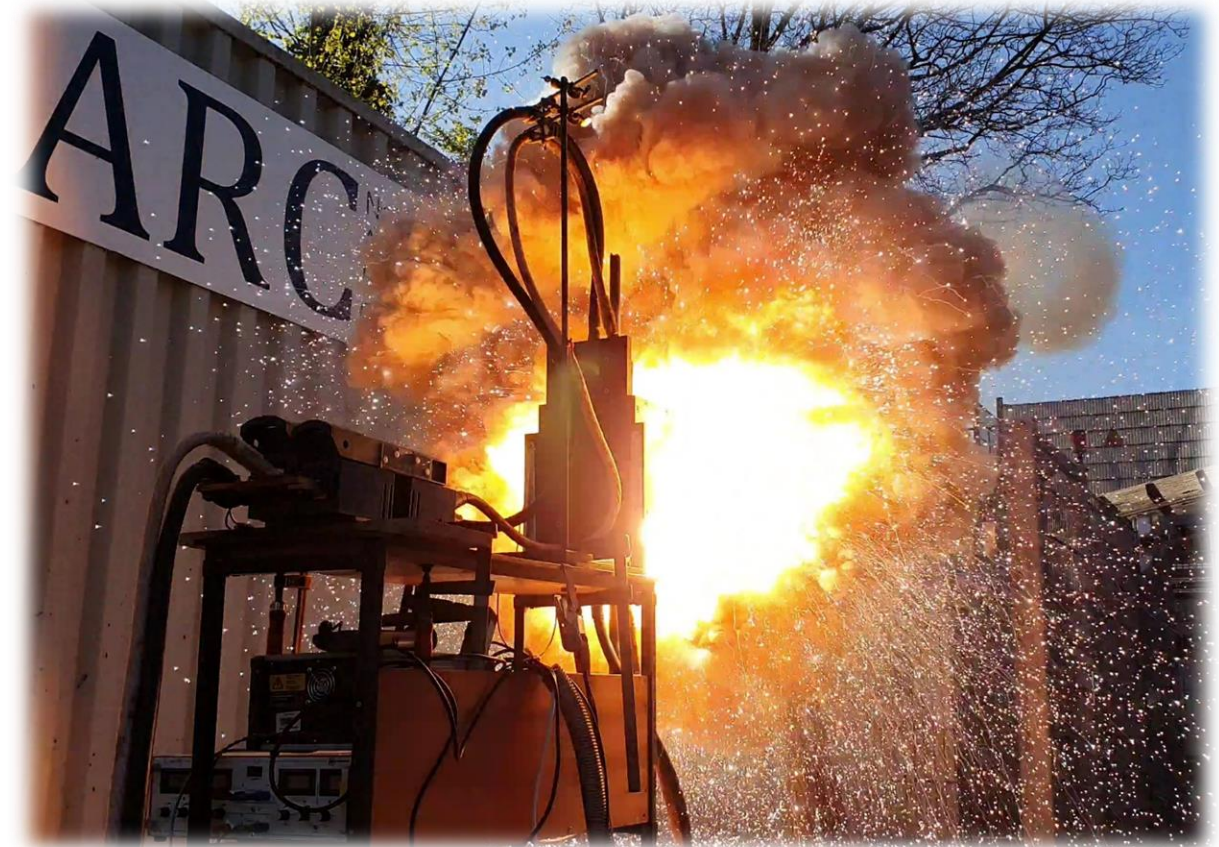
Bild eines Störlichtbogenversuchs im Hochleistungsprüffeld „NARC“ des Projektpartners TU Dresden
