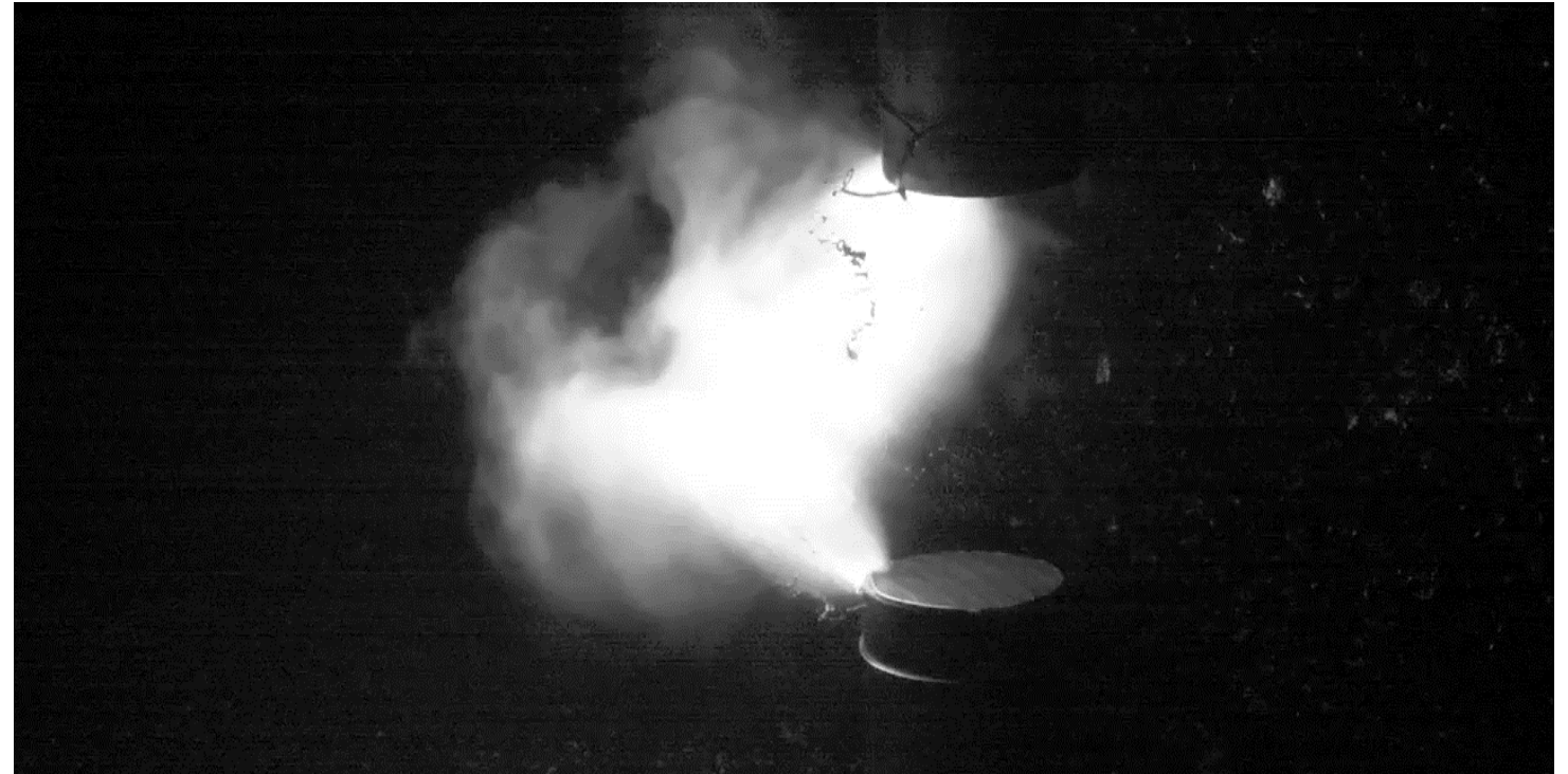
Aufnahme von AC-Lichtbogen: ca. 25 Netzperioden, 150-fach verlangsamt
