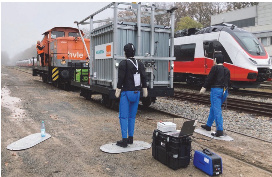
Abb. 4: Außentests bei der HVLE – Erprobung der Perception unter realitätsnahen Bedingungen Quelle: [3]
