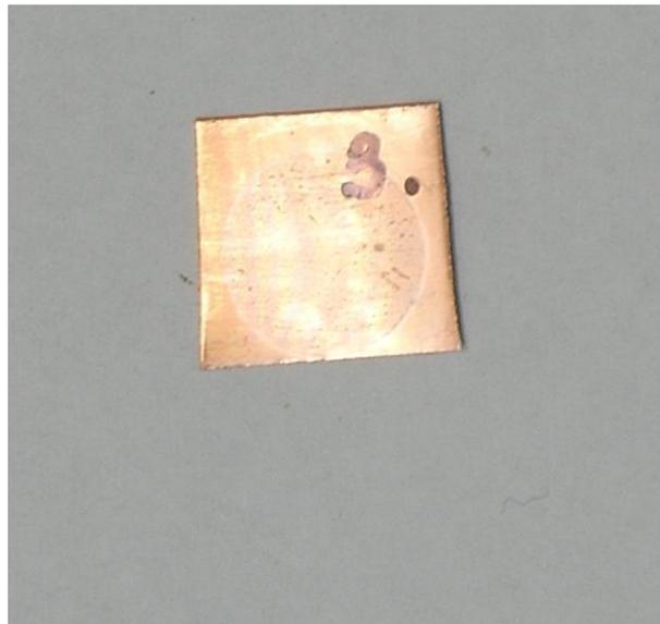
**Abbildung 7.10: Parylenbeschichtete Kupferprobe nach der Protonenbestrahlung:** Es ist die schwache Verfärbung zu sehen, die der Protonenstrahl an der Parylenschicht hinterlassen hat.
