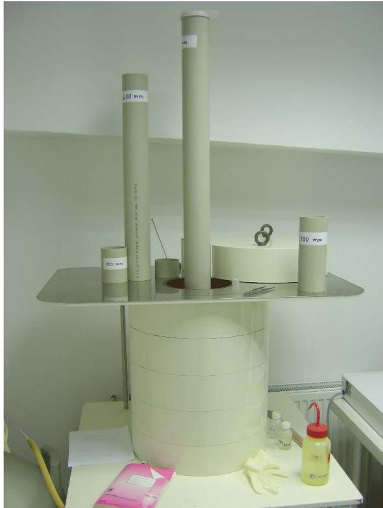
**Abbildung 8.7: Der HP-Ge Gammadetektor:** Zu sehen ist die Bleiburg, in der sich der Germaniumdetektor befindet. Darauf platziert sind die verschiedenen Abstandhalter.
