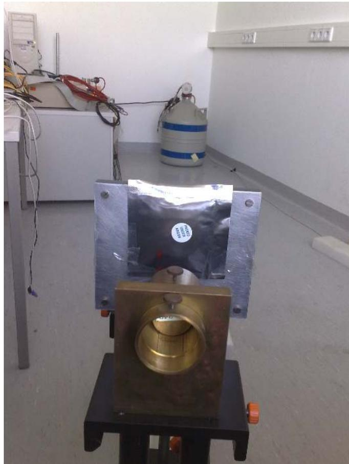
(a) Im Vordergrund ist die  $^{241}\text{Am}$ -Quelle, eingespannt in eine Halterung, zu sehen. Davorgespannt ist die Neodymfolie in ihrer Verpackung, in der Argonatmosphäre herrscht. Im Hintergrund ist der Germanium-Detektor zu sehen.
