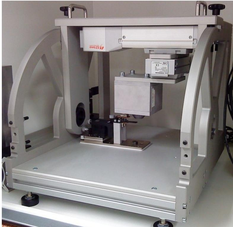
**Abbildung 5.4.4:** Messstand mit Schrittmotoren und Kollimator in Position für Messungen an Seite 4.
