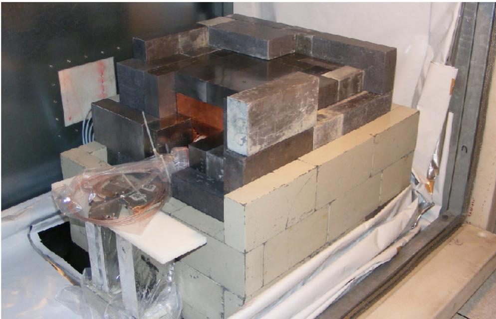
**Abbildung 3.2.2:** Unvollständiger Aufbau. In der Mitte ist das Kupfer-Nest zu erkennen, umgeben von zwei Schichten Blei: Innen sehr niedrig radioaktives Blei, außen gewöhnliches Blei. Es folgt die radon-dichte Folie (weiß), dann eine EMV-Box und zuletzt das Polyethylen-Neutronenschild (weiß, am rechten Bildrand), aus [Ned11].
