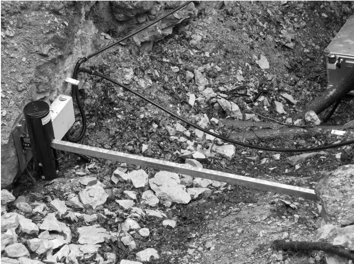
Abb. 3: Spalte mit Extensometer im Testgebiet Balingen
