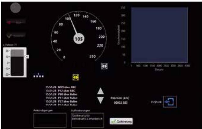
**Abb. 6:** Screenshot: Simulation von Levelwechsel L2 nach L1 LS
