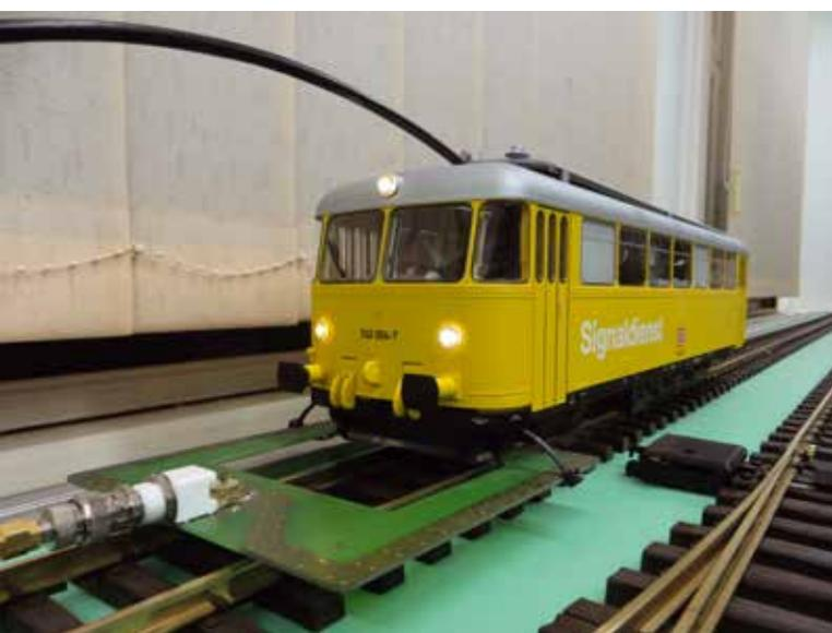
**Abb. 4:** Modellfahrzeug mit Leseantenne
