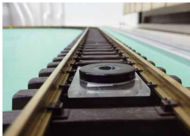
**Abb. 5:** Frei positionierbare Modellbalise im Gleis
