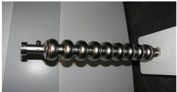
Abb.2 Hohlraumresonator am DESY in Hamburg
