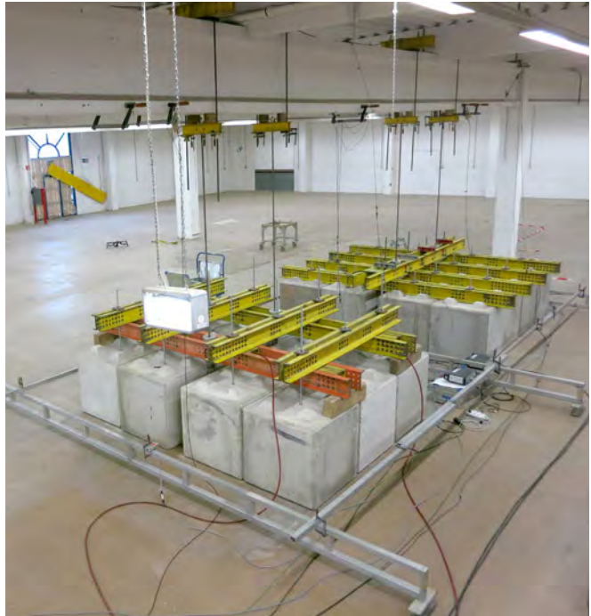
Bild 8: Test eines Spannbetonbinders mit angebohrten Spannritzten
