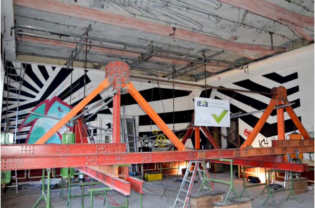
Bild 10: Belastungsrahmen und Messtechnik im ehemaligen Sitzungssaal
