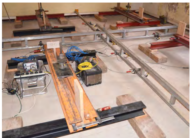
Bild 9: Lasteinleitung sowie Messbasis mit zugehörigen Wegaufnehmern
