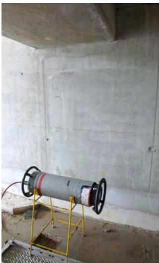
Bild 10: Prüfaufbau mit Röntgenröhre (links) und Detektor (Speicherfolie, rechts)
