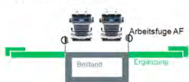
Bild 1: Beispiele von möglichen Betonierarbeiten an Brücken, bei welchen Erschütterungen auf den jungen Beton erzeugt werden (schematische Schnittdarstellung eines typischen Tragwerks; grau: Bestand; grün/blau: Neubau)
