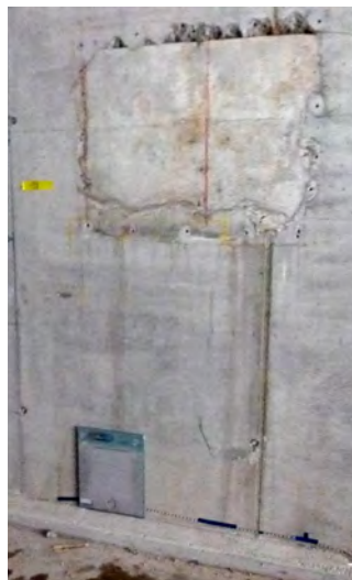
Bild 10: Prüfaufbau mit Röntgenröhre (links) und Detektor (Speicherfolie, rechts)
