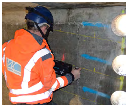
Bild 8: Durchführung der Ultraschallmessungen nach dem Durchtrennen der Spannglieder
