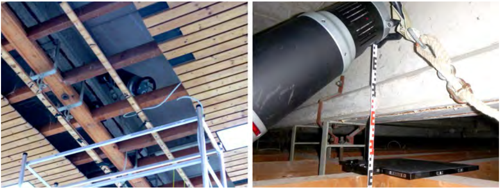
Bild 4: Anordnung von Röntgenröhre und Digitaldetektor für die Durchstrahlungsprüfung (exemplarisch)
