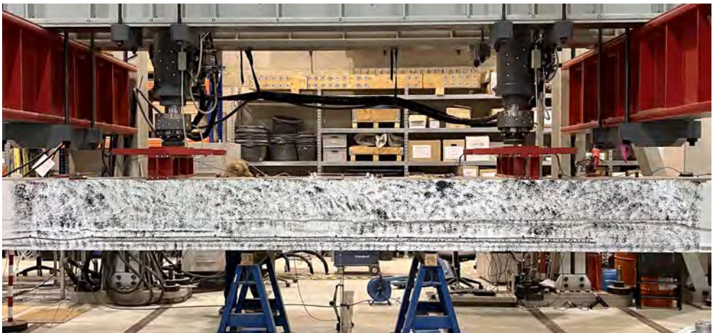
Bild 6: Probekörper im Belastungsrahmen mit Oberflächenmuster für DIC-Messung
