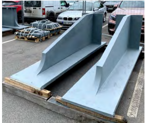
Bild 7: Vorgefertigte Einbauteile der Sonderkonsolen
