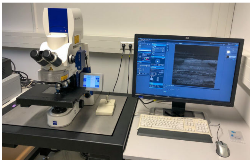
Abbildung 3.7: Messplatz mit Zeiss LSM 710 und Steuerungs-PC
