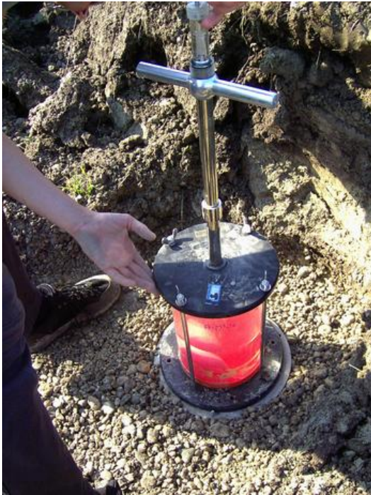
Abbildung 3: Direkte Dichtebestimmung in situ mit dem Ballonverfahren nach DIN 18125-2.
