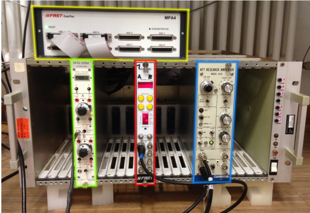
**Abbildung 3.6:** Foto der verwendeten Ausleseelektronik. Abgebildet ist das NIM-Modul (grün umrandet) zur Spannungsversorgung, der ADC (rot umrandet), der spektroskopische Verstärker (blau umrandet) sowie der MPA (gelb umrandet). Nicht dargestellt ist der Vorverstärker, welcher fest am hinteren Teil des Detektors verbaut ist.
