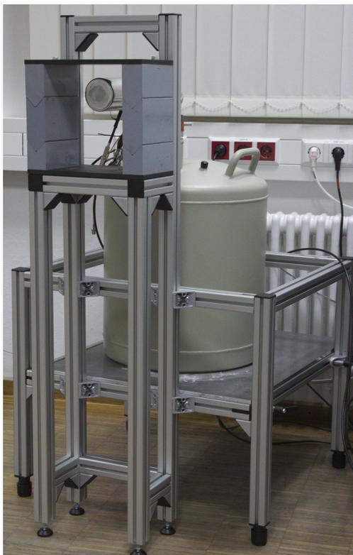
**(a)** Foto des Detektors, der höhenverstellbaren Halterung, sowie der zur Kühlung benötigten Stickstoffkanne.
