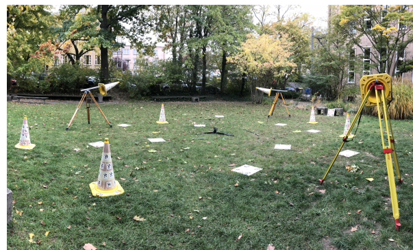
Abbildung 2: Kalibrierung des Scanners auf einem Testfeld auf dem Gelände der TU Dresden
