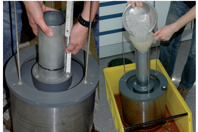
Bild 7: Ziehen des Ausstechzylinders (links) und Einfüllen des Sandes (rechts) Figure 7: Withdrawing the cutting cylinder (left) and pouring in sand (right)
