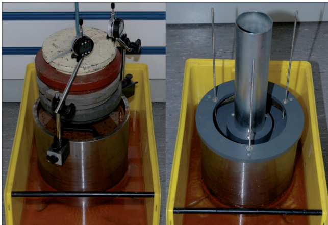
Bild 6: Vorkonsolidation des weichen Bodens (links), Haltevorrichtung für Ausstechzylinder (rechts) Figure 6: Preconsolidation of the soft soil (left), holder for cutting cylinder (right)
