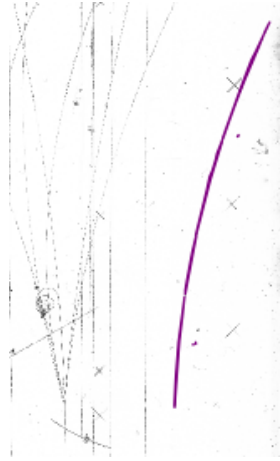
Abbildung 2.13: Die violett hervorgehobene Spur hinterließ ein Proton, das durch ein Neutron aus der Kammerflüssigkeit herausgelöst worden ist.
