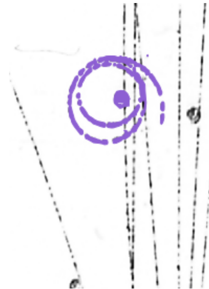
Abbildung 3.4: Compton-Streuung auf einer Blaskammeraufnahme: violett hervorgehoben ist die Spur des Elektrons
