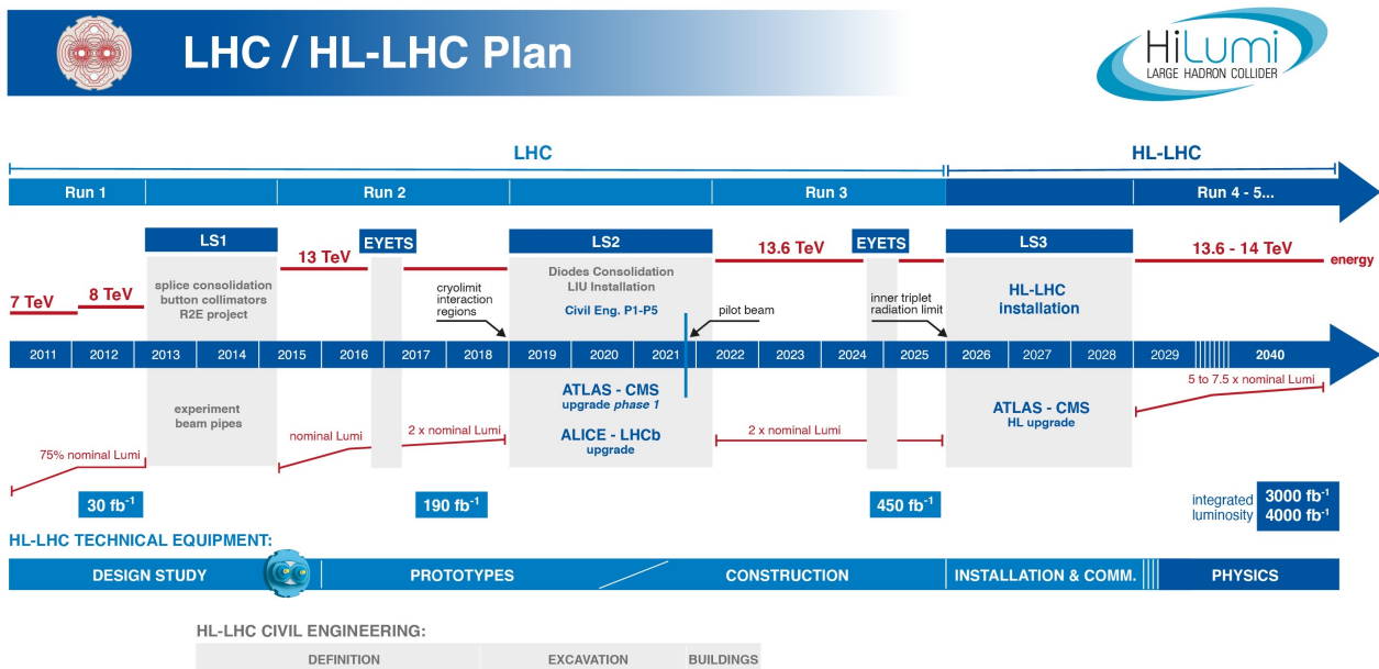
Abb. 2: Übersicht der Betriebsphasen des LHC bzw. HL-LHC. [3]
