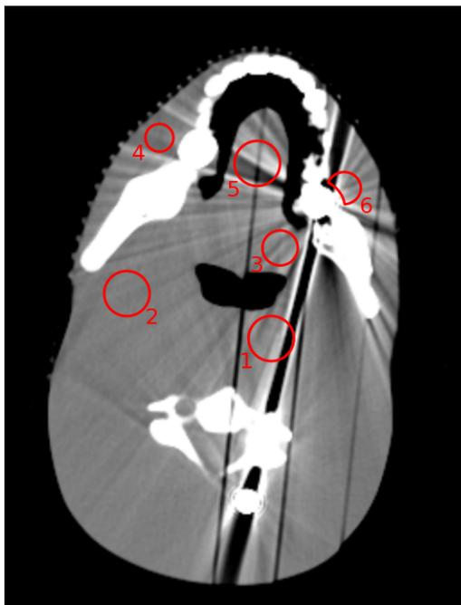
**Abbildung 3.3:** D34-Kern, Kopfphantom mit den eingezeichneten ROIs. 1. Gewebe 1, 2. Gewebe 2, 3. Gewebe 3, 4. Wange 1, 5. Zunge, 6. Wange 2. Bei der ROI in der Zunge wurde der Schlitz über einen Schwellwert in einem Referenzbild ohne Zahnfüllung ausgenommen, damit nur ein homogenes Gewebe analysiert wird.
