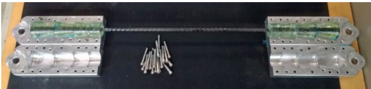
Bild 2 Inverssegmentierte Vergussverankerung für Zugversuche. Foto aus [10]
