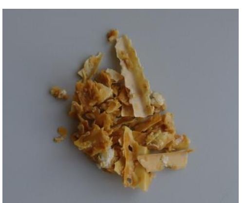
Ablagerungen auf den Wärmetauscherplatten des Feed-Vorwärmers der wasser-abtrennenden Rektifikationsstufe
