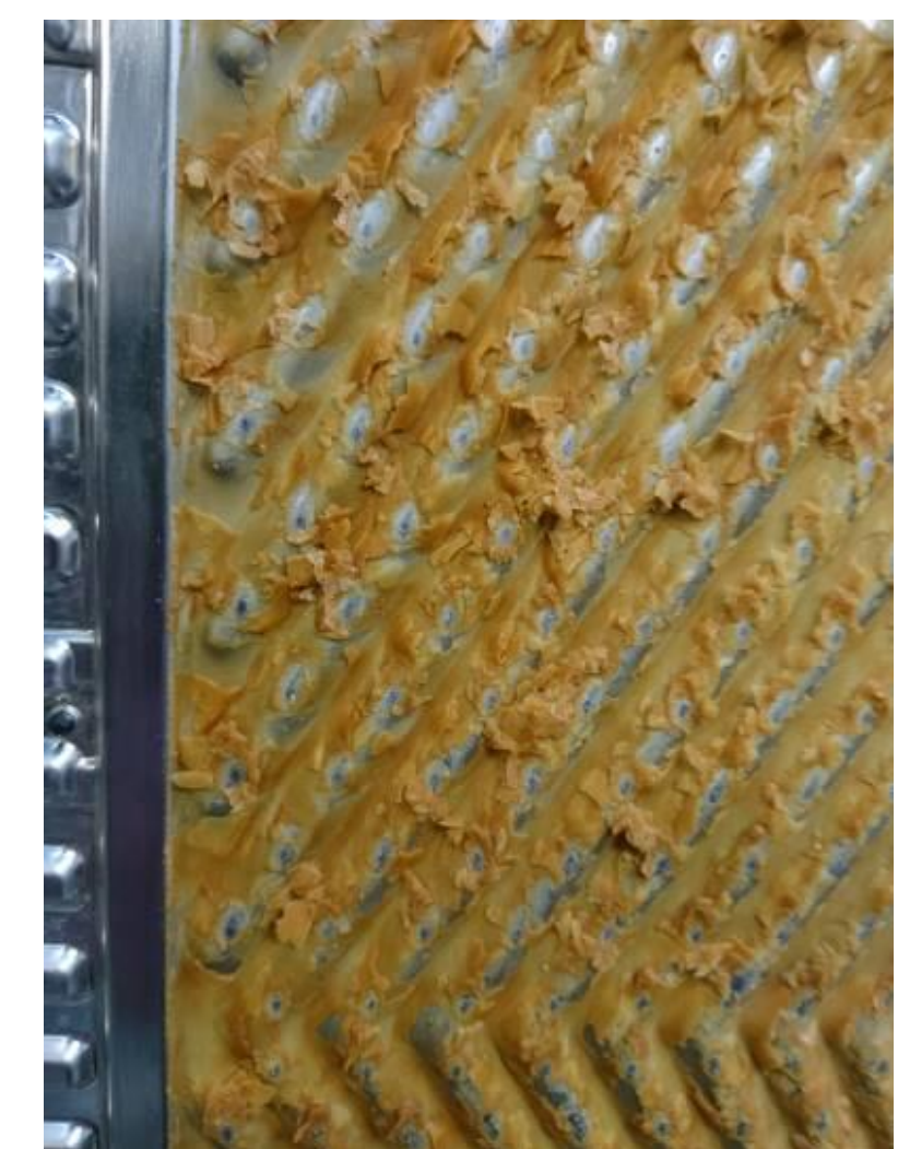
Ablagerungen auf den Wärmetauscherplatten des Feed-Vorwärmers der wasser-abtrennenden Rektifikationsstufe
