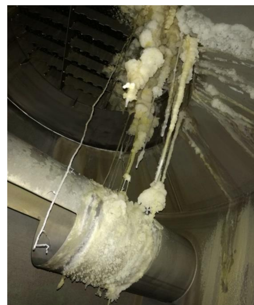
Blick durch das Schauglas über dem Kolonnensumpf der wasserabtrennenden Rektifikationskolonne mit Tragerost, Zufluss vom Fallfilmverdampfer und den Ablagerungen
