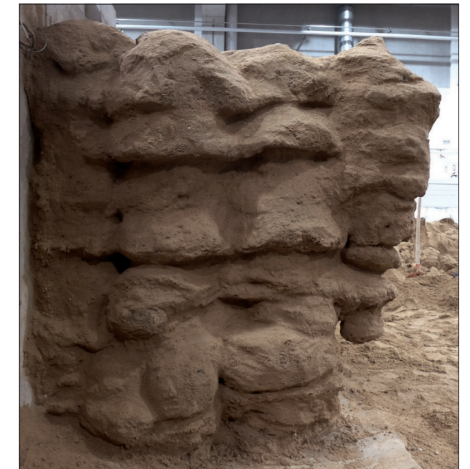
Bild 3: Durchgängige, geschlossene Dichtwand (GR3) Figure 3: Continuous sealing wall
